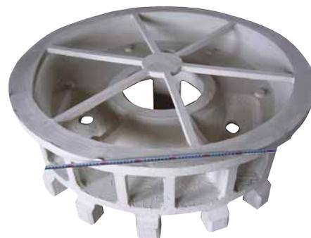
емная литейная форма как бы «исчезла» в ее традиционном понимании, ее заменила литейная форма в виде засыпки модели сухим песком в ящике (контейнере). При заливке этой формы металл испаряет модель и замещает ее собой.
