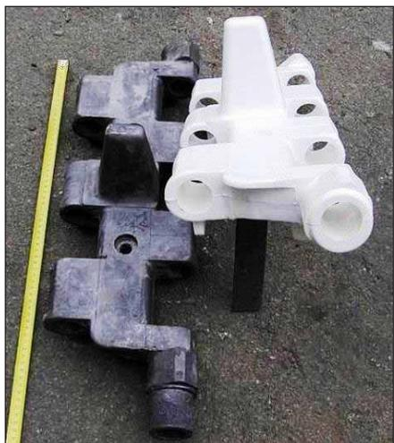
лить десятки отливок, как в ювелирном производстве, обычно с почти «ювелирной» точностью. До 90% отливок можно применять без механической обработки.
